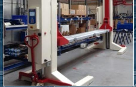
Traverse disponible pour le levage par trains de roulement ou châssis.
