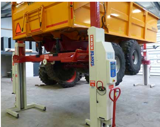
Dwarsbalk voor voertuigen met lage bodemvrijheid voor wielvrij onderhoud.
