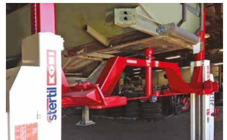
Trailer King-Pin dwarsbalk voor het veilig, stabiel en zelfstandig heffen van een ontkoppelde oplegger.
