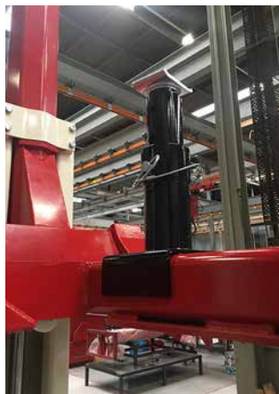
Dwarsbalk voor voertuigen met lage bodemvrijheid voor wielvrij onderhoud.
