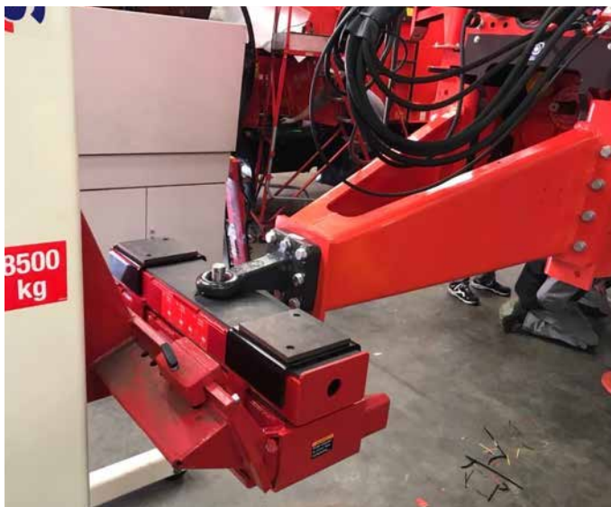
Multifunctionele adapters om het voertuig aan de voor- of achterkant wielvrij te heffen met twee of drie mobiele hefkolommen.
